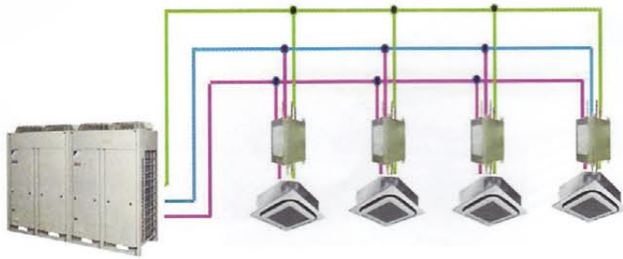
Wärmerückgewinnung im 3-Leiter-System
